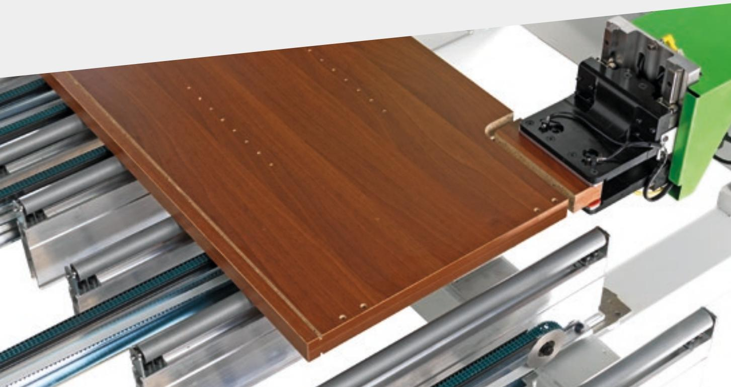
Flexibilité totale pour le façonnage de panneaux de dimensions et épaisseurs différentes. Façonnages sans interruption, simultanément sur la partie supérieure et inférieure, sans devoir repasser les panneaux plusieurs fois dans la machine.
