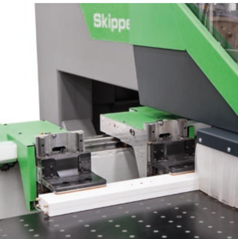
Pour démarrer, il suffit d'avoir à bord le programme de travail ; pas besoin d'outillage, de réglage ni d'essai grâce au système de blocage du panneau au moyen d'étaux à positionnement automatique.
