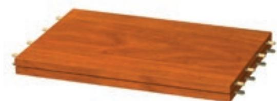
Système d'injection de la colle et d'insertion des tourillons avec deux groupes opposés pour le façonnage des deux extrémités du panneau.
