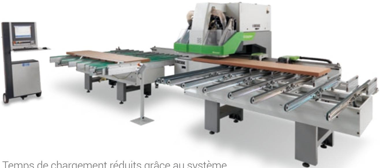
Temps de chargement réduits grâce au système automatique de positionnement des panneaux qui sont placés contre les butées de manière automatique.
